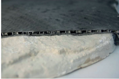
Experimentació sobre la rèplica: detall de zona del suport tallat amb disc i comprovació de l'adhesió i de l'acoblament sobre la superfície.
