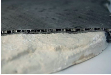
Experimentación sobre la réplica: detalle de zona del soporte cortado con disco y comprobación de la adhesión y del acople sobre la superficie.
